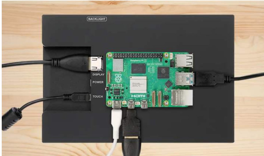
Figuur 3.10: Elecrow 8 inch IPS-touchscreen ( 1280 \times 800 ) voor lokale bediening en visualisatie van de trackingstatus. Het scherm is een gebruiksgemakuitbreiding; de basistracker kan ook zonder touchscreen via SSH gebruikt worden [46].
