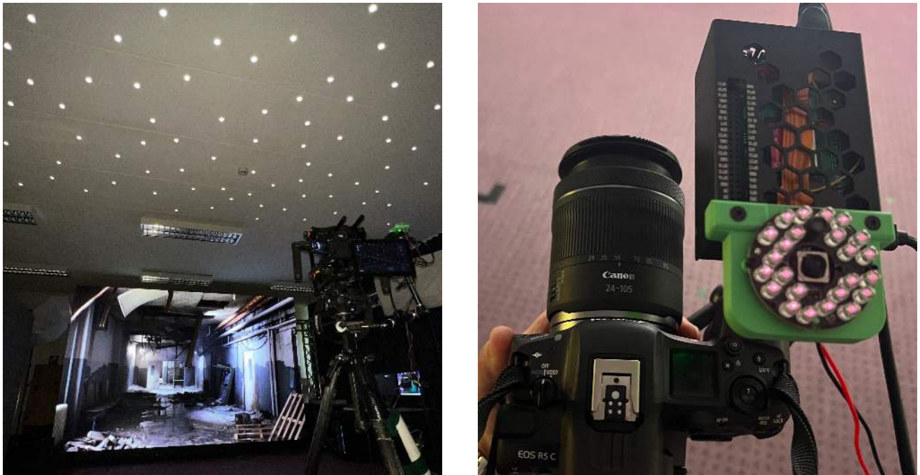
Figuur 5.11: Opstelling voor de prestatie- en integratie-evaluatie met LED-wall en opnamecamera. Links wordt de statiefrig gebruikt; rechts is het prototype rechtstreeks op de opnamecamera gemonteerd voor vrije cameratracking en eindbeelden.
