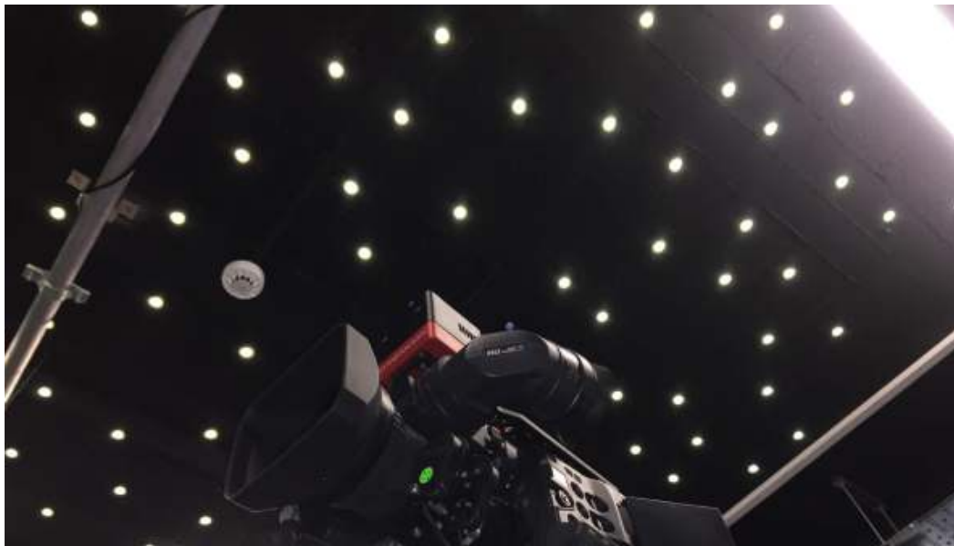
Figuur 1.7: Mo-Sys StarTracker gemonteerd op een studiocamera; de trackingkop kijkt omhoog naar retroreflectieve sterren op het plafond en gebruikt die als vaste referentie voor inside-out cameratracking. Bron: [13].
