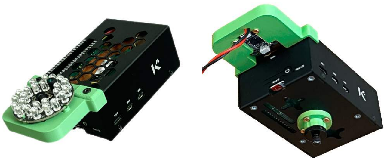
Figuur 3.1: Finaal prototype van de trackingmodule. Links is de bovenzijde met trackingcamera en IR-ledring zichtbaar; rechts is de onderzijde met IMU en bevestiging zichtbaar.
