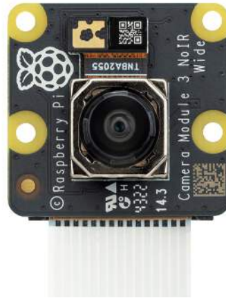
Figuur 3.3: Raspberry Pi Camera Module 3 NoIR Wide met IMX708-sensor en brede lens. De brede beeldhoek vergroot het zichtbare plafondgebied en verhoogt de kans dat voldoende markers in één frame aanwezig zijn. Bron: [43].
