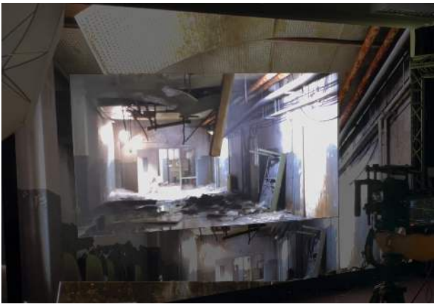
(a) Inner frustum op de LED-wall, gegenereerd door nDisplay . Alleen het zichtbare gebied van de opnamecamera wordt in hoge kwaliteit weergegeven.
