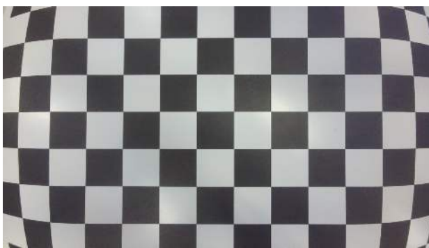
(a) Ruw camerabeeld met zichtbare radiale vervorming aan de beeldranden.
