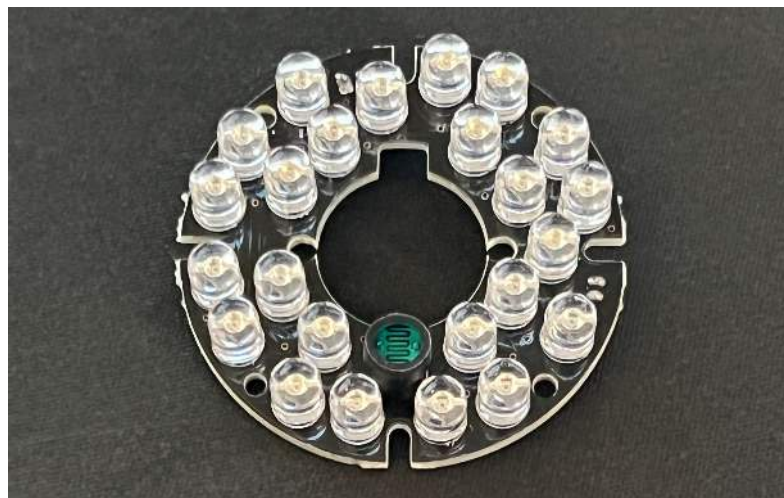
Figuur 3.4: IR-ledring met infraroodleds, geplaatst rond de trackingcamera voor retroreflectieve belichting van de plafondmarkers.
