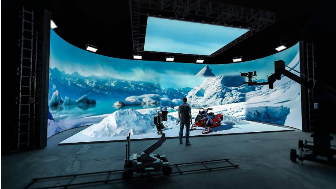
Figuur 1.1: Voorbeeld van een virtual-production-opstelling waarin een LED-wall, een fysieke camera en een virtuele omgeving samen één opnameketen vormen. Bron: [1].
